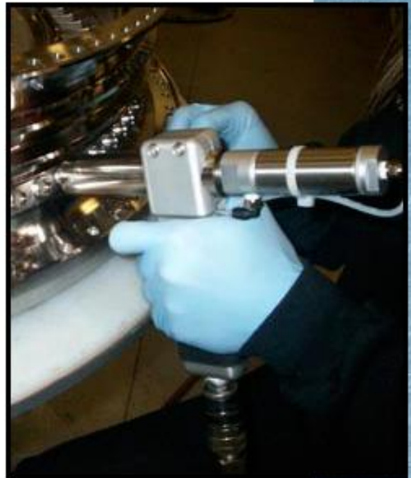
Durham, NCGE 에 위치한 GE항공에서 HRP-1 툴로 비행기 엔진에 스냅링을 장착하는 모습
